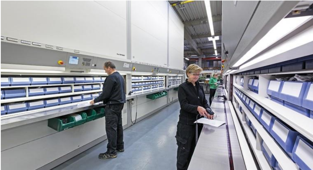
Paternoster ermöglichen einen effizienten Zugriff auf etwa 16.000 Ersatzteile
