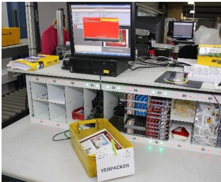
Digital Print führt auch Aufträge von Großkunden aus. Je nach Großkunde, Empfänger und Artikel kommen noch Beilagen hinzu. Diese werden durch LEDs an jedem Arbeitsplatz angezeigt. Fertige Sendungen transportiert ein Förderband zum Verpacken.
